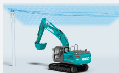
電線や橋など上部への接触防止
