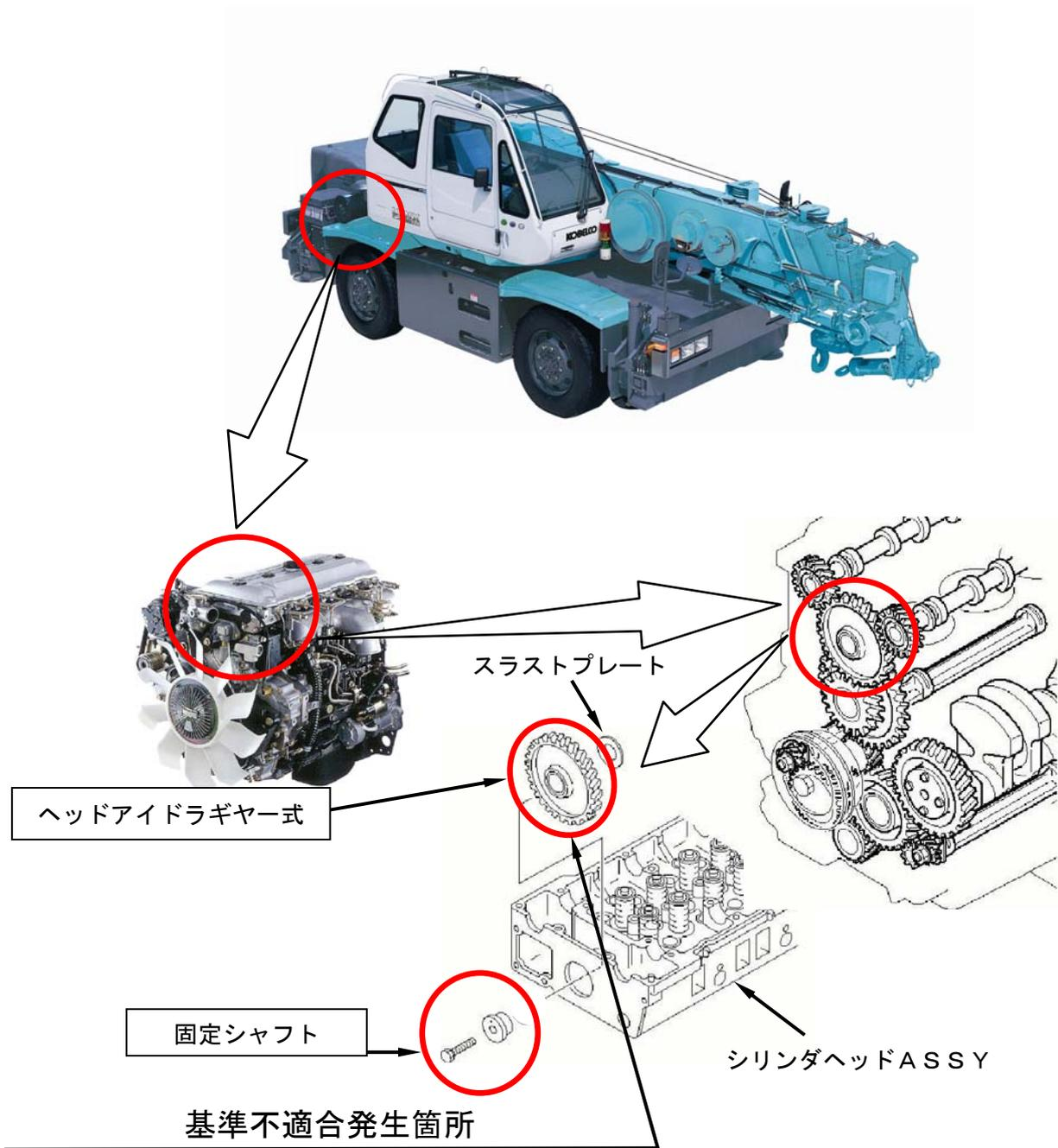
原動機のカムシャフト駆動用ヘッドアイドルギヤのブッシュの材質に不適切なものがあるため、ブッシュが早期に摩耗してブッシュと固定シャフトの間にガタが生じるものがある。そのため、そのまま使用を続けると、シャフトつば部の付け根に過大な応力が発生することがあり、つば部が破損してギヤが周辺部品と干渉し、異音が発生する。又はエンジンオイルが漏れ、最悪の場合、当該ギヤの噛み合いが外れて、エンジンが停止し再始動不能となるおそれがある。
